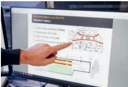
↑ Des éléments de compression agissent comme un tampon lorsque la montagne pousse sur le revêtement de béton projeté.
