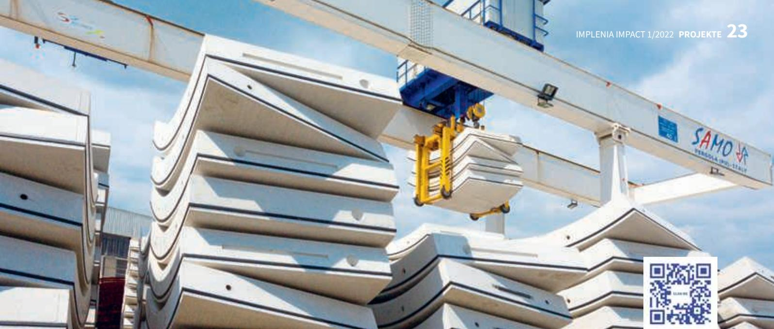
↑ Im Werk in Limoges-Fourches, eine Stunde ausserhalb von Paris, produzieren 180 Mitarbeitende Betonelemente für den Tunnelbau
