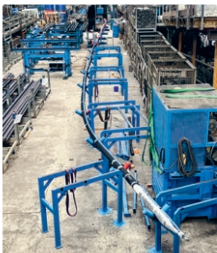
↑ Nuove dimensioni: per gli ancoraggi di Groningen, BBV Systems ha allungato le linee di produzione.
