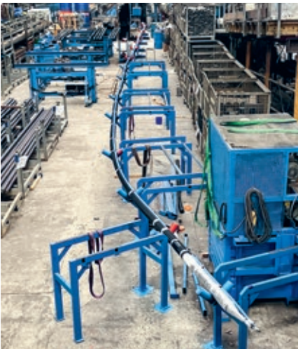
↑ Neue Dimensionen: Für die Anker von Groningen verlängerte BBV Systems die Fertigungslinie
