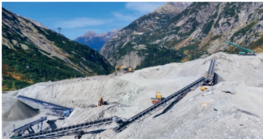
↑ Kreislaufwirtschaft: Für die Betonherstellung wird der Felsabtrag aus der Staumauer und anderen Projekten genutzt
