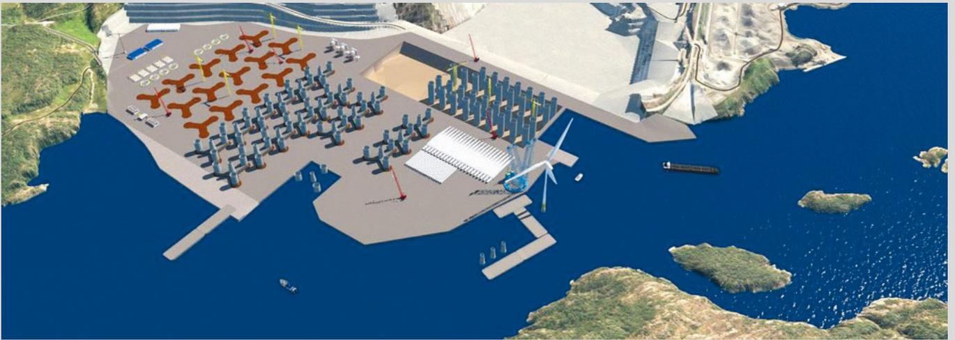
↑ In Norvegia, Implenias e WindWorks Jelsa desiderano costruire un impianto per la costruzione di fondamenta in calcestruzzo per parchi eolici offshore galleggianti.
